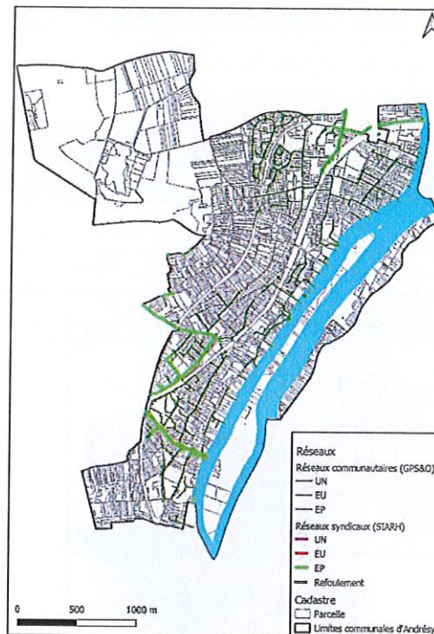
Cartographie du réseau d'assainissement communautaire EP d'Andrésey
