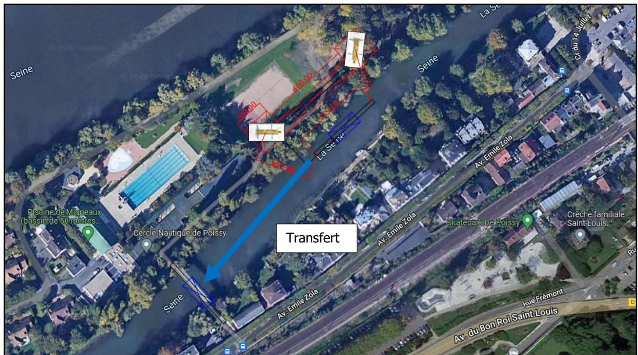
Figure 19 - Fabrication d'une passerelle - principe de manutention
