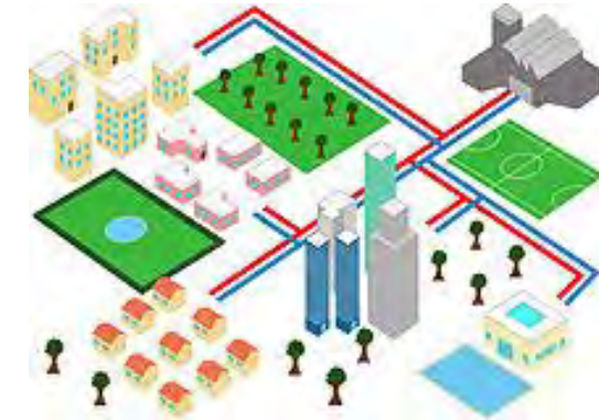
Une alimentation des réseaux via l'unité de biomasse du Val Fourré (60%)
