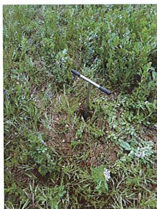
Les sondages permettent de caractériser les hauteurs utiles du sol pour le traitement et la dispersion des eaux traitées à savoir :
