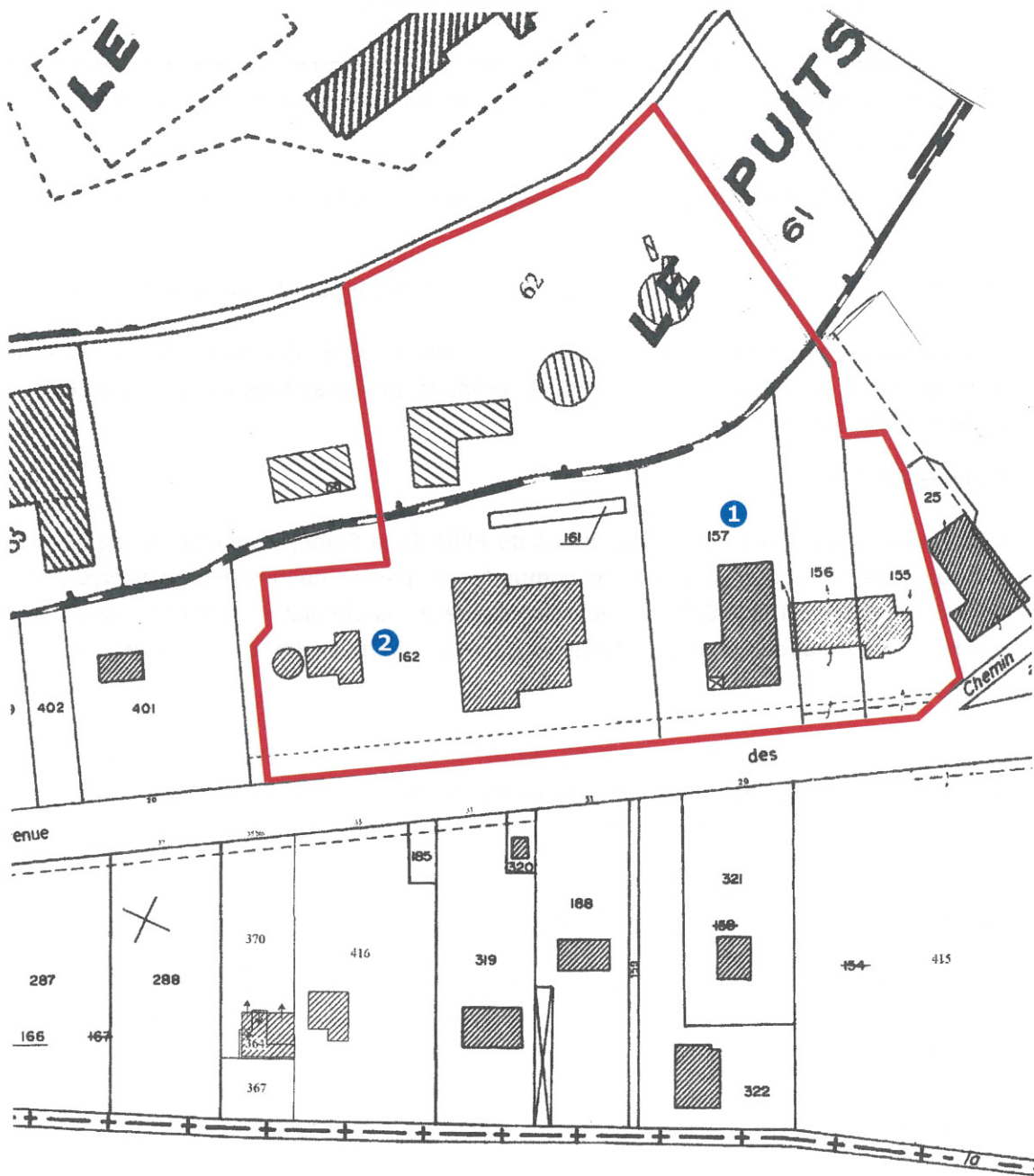
Figure 7. Périmètres de protection immédiate des forages F1 et F2.
