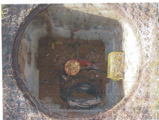
Le piézomètre (désigné par D) situé dans le PPI de F3 et F6
