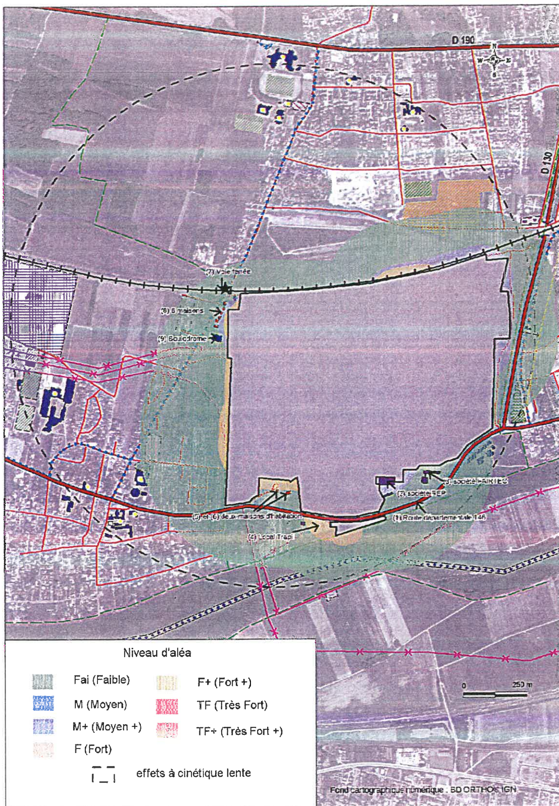
Carte 9 : Superposition de la carte des enjeux et de la carte des aléas tous effets confondus.
