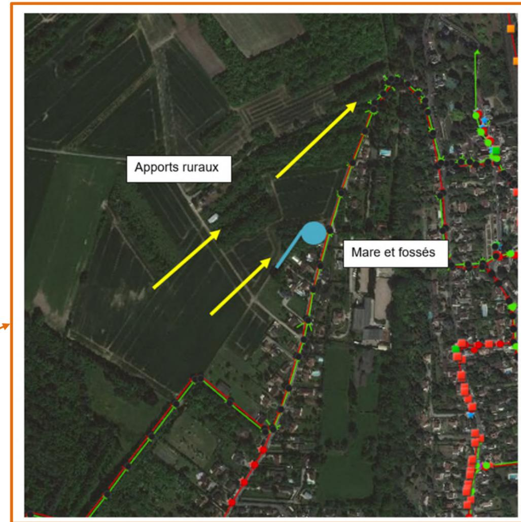
Rue de Breteuil, le ruissellement provient également du plateau agricole, des aménagements ont été réalisés sur le secteur (drainage par fossés et retenue par une mare) afin de maîtriser en partie les écoulements. A noter que ces ruissellements sont impactants pour le réseau SIARH (et non communal).
