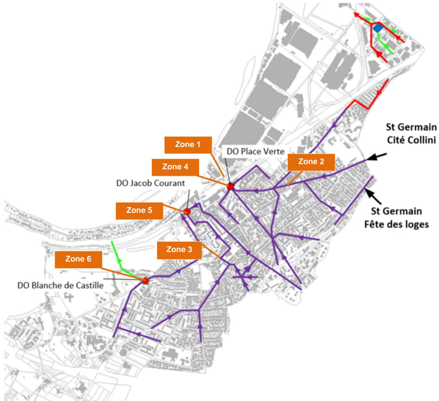
**Zone 1 :** Des débordements des réseaux d'eaux pluviales et unitaires ont été constatés à l'aval du Rond-Point de l'Europe, sous le pont SNCF (point bas topographique). Ces dysfonctionnements seraient directement imputables à la crue de la Seine de Janvier 2018 (remontées d'eaux de Seine dans les réseaux) et à un dysfonctionnement d'un poste anti-crue.
