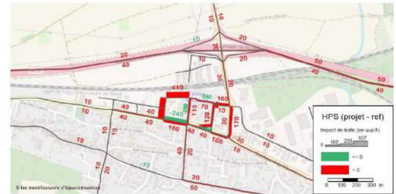
Différence de trafic à l'HPS en 2030, avec et sans projet – Source : Ingérop
